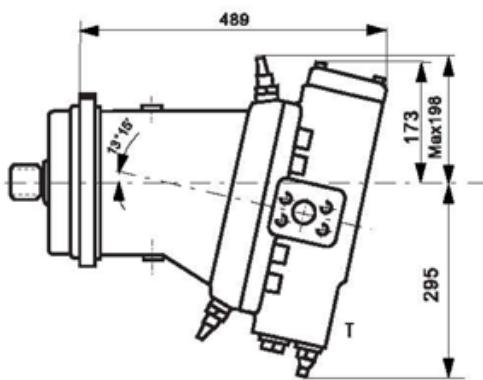
EP 电控变量 Electric Control
