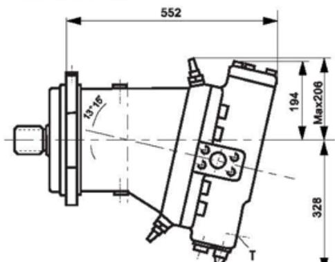
EP 电控变量 Electric Control
