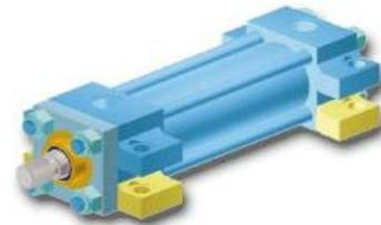
As montagens tipo FL e CL têm, nas orelhas, espaço suficiente para a instalação de cavilhas para que, sob altas pressões, o posicionamento do cilindro não seja garantido unicamente pelos parafusos de montagem. As cavilhas devem ser instaladas numa das extremidades, para evitar mudança de posição do cilindro sob carga pesada. Em cilindros longos, freqüentemente são necessárias orelhas intermediárias.
