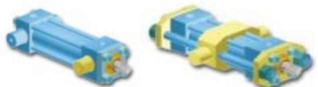
Os cilindros montados por pivôs, tipo RT, IT e HT também se destinam a cilindros que necessitem de movimento circular. Estes requerem blocos de apoio de tamanho, resistência e rigidez suficientes para apoiarem os pinos dos pivôs em toda sua extensão. Os pivôs constituem uma só peça de aço laminado, requerem lubrificações periódicas e foram dimensionados para suportar tensões de
