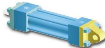
Os cilindros com montagem por aleta tipo MC e FC, são destinados para as instalações onde seja necessário movimento pivotado do cilindro, para aliviar cargas radiais excessivas. O pino foi dimensionado para resistir ao cisalhamento e não a flexão, e deve ser lubrificado periodicamente. Veja em “dimensões” os números das peças que podem ser fornecidas em separado são as mesmas.
